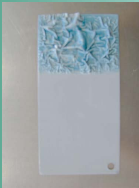
Peinture PU bi-composante - DEXCEL REV 85 G & L début de cloquage après 9 minutes.
