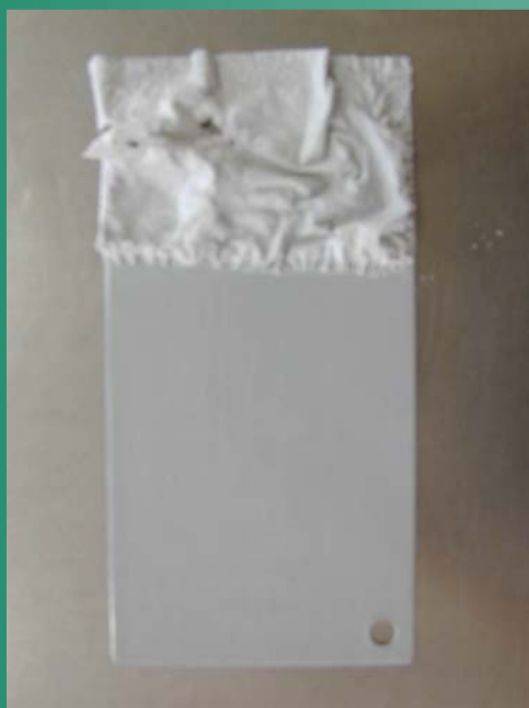
Peinture PU bi-composante - DÉCAPANT CLASSIQUE à base de Chlorure de Méthylène, début de cloquage après 12 minutes.
